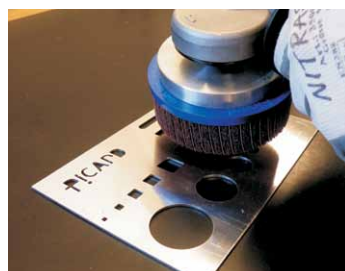
Entgratscheifsteller FAPI-M14 im Einsatz auf einem Winkelschleifer
