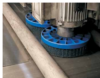
Entgratscheifsteller FAPI-250 im Einsatz auf einem Loewer DiscMaster 4TD
