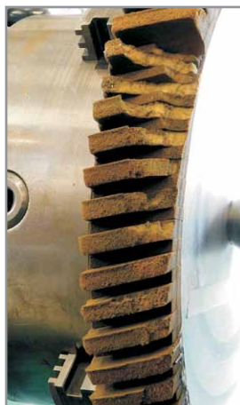
Kontaktschleifplatte mit einem Altbelag aus Lamellen aus aufgeschäumtem Vulkollan®
