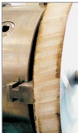
Kontaktschleifplatten-Kern nach dem ersten Abdrehvorgang.
