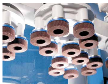
Entgratscheifsteller FAPI-TRIM auf einem Planetenkopfsystem
