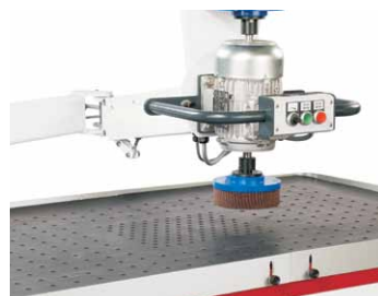
Entgratscheifsteller FAPI-150 auf einem Manual Grinder der Firma Timesavers B.V.
