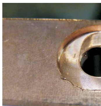
Werkstück vor und nach der Bearbeitung mit einem Entgratschleifteller FAPI-M14 SAND auf einem Winkelschleifer.
