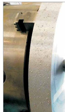
Kontaktschleifplatten-Kern nach dem finalen Abdrehen - bereit für einen Neubezug.
